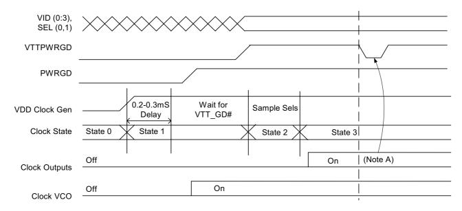
Figure 6. VTTPWRGD Timing Diagram<sup>[8]</sup>
